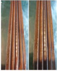
مسیر جوشکاری پالسی در نمونه خارجی
